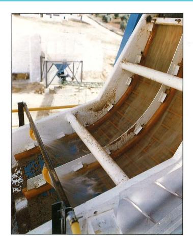
La criba Vibrosieve ha sido especialmente diseñada para clasificaciones finas entre 0,25 mm. y 2,0 mm. Sus principales aplicaciones son:
